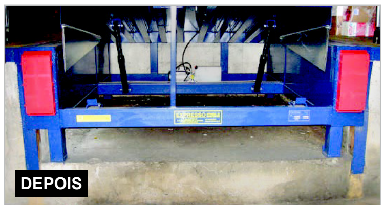
Nivelador para cofragem, para fosso não definido (com ou sem espaço para plataforma elevatória de camião)
